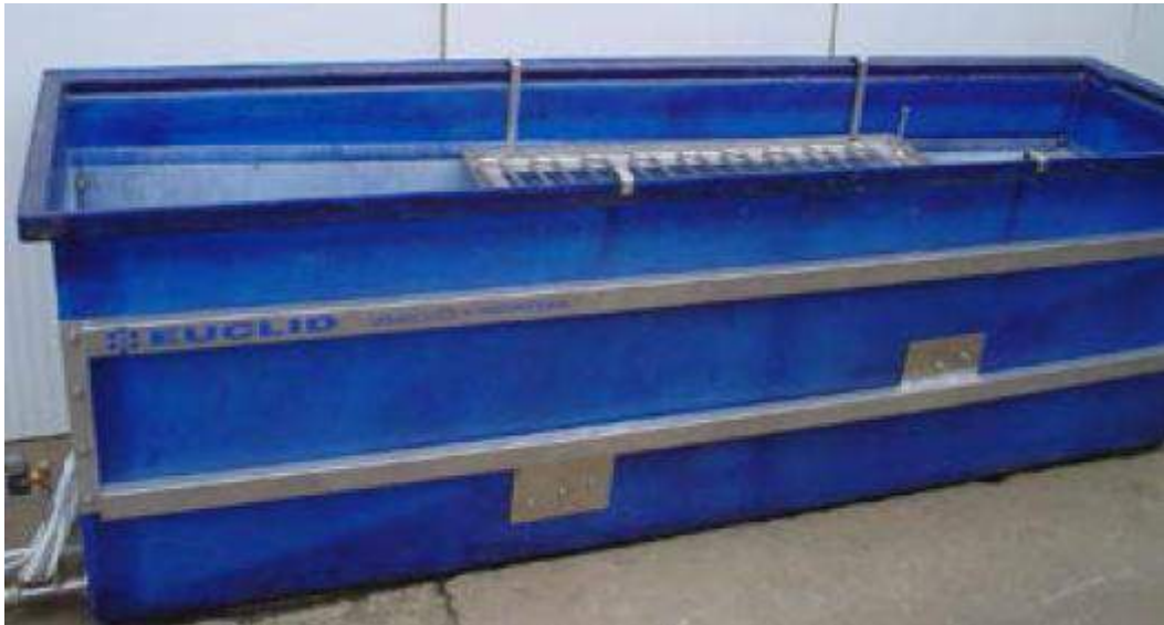
Slika 9. Hladnjak boca i vreća s rekuperativnim predgrijačem soka
